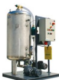
Sistema integrato automatico idoneo alla raccolta e al pompaggio di acque nere e di sentina, conforme al decreto Lgs. N. 182 del 24 giugno 2003 (G.U. 22 luglio 2003, n. 168). Il sistema è composto da elettropompe autoadescanti J in bronzo, serbatoi in acciaio inox AISI 316, elettrodepressore, sensore di livello, quadro di controllo e basamento in acciaio.
