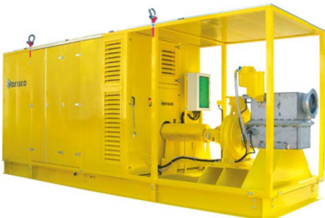
Sistema di pompaggio ad alta pressione per il collaudo idrostatico di metanodotti e oleodotti. Il gruppo è costituito da una pompa centrifuga multistadio orizzontale. Allestimento su skid con protezione in profilati di acciaio e con cabina di insonorizzazione motore.
